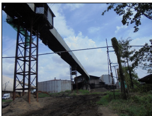
รูปที่ 14 สายพานลำเลียงขานอ้อยระบบปิดครอบ
