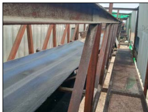
รูปที่ 14 สายพานลำเลียงขานอ้อยระบบปิดครอบ
